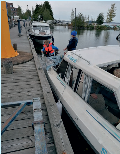
KUVA 1: Veneen muut kiinnitysköydet on irrotettu ja springiköysi valmisteltu. Veneen perää suojataan ”irtofenderillä”.
