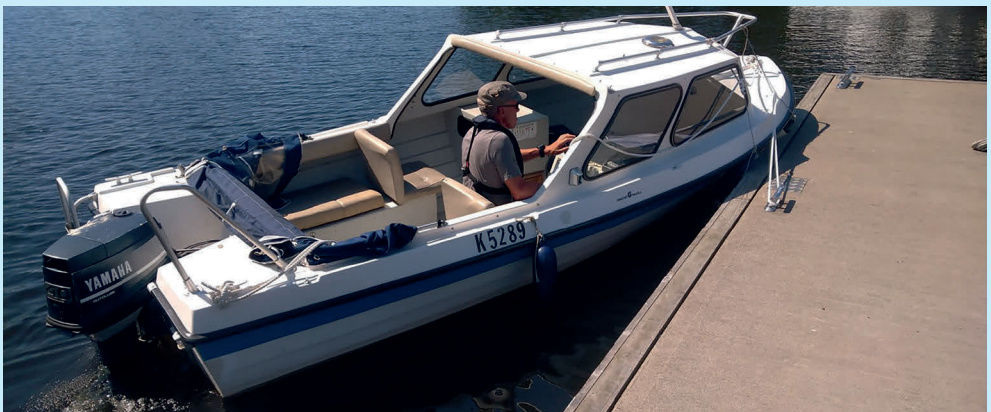
KUVA 2: Vaihde kytketään eteenpäin ja käännetään ruori kohden laituria. Springiköysi estää venettä liikkumasta eteenpäin, sen sijaan perä irttaa laiturista. Kaasua käytetään vain sen verran, että vene lähtee kääntymään. Kovemmalla tuulella voidaan joutua lisäämään varoen kierroksia.
